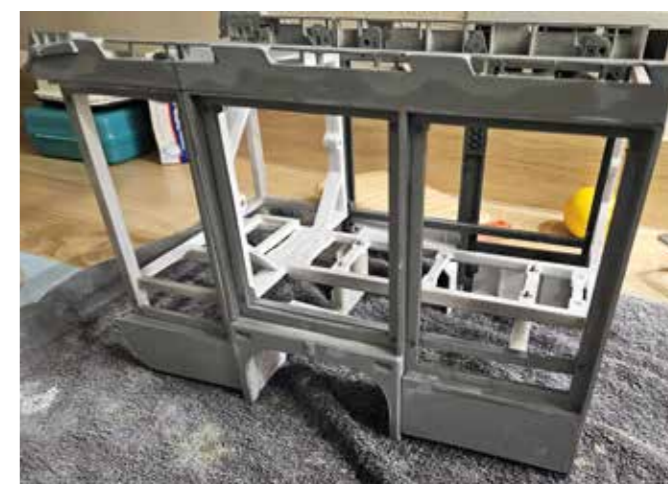
Der Aufbau nach Anwendung des Spritzspachtels
