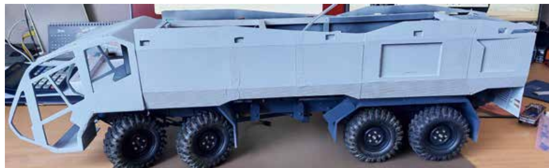
Ein Blick auf den Aufbau des 8x8-Fahrzeugmodells mit sichtbarem Spritzspachtel
