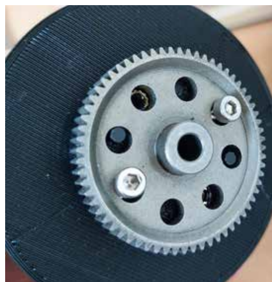
Der Drehkranz ist mittig unter dem Arm platziert und oberhalb der Dachabdeckung verschraubt
